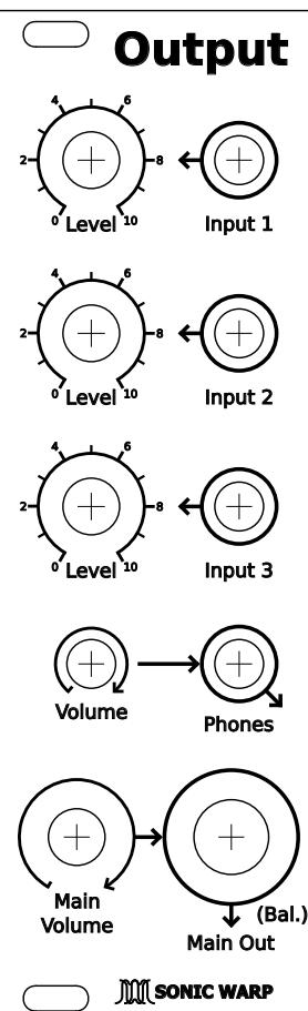
Ceci est un module de sortie symétrique avec 3 entrées atténuables ainsi qu'une sortie casque. Il permet d'envoyer un signal sur de très grandes longueurs de câble.
